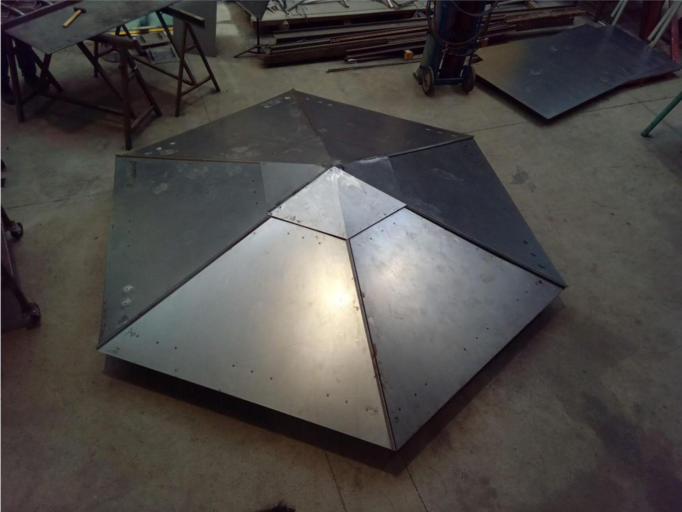
La toiture pyramidale à base hexagonale doit ressembler à ça une fois montée.
